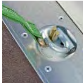
4 - 6 Zurrmulden versenkt im Bodenrahmenprofil Dekra zertifiziert
