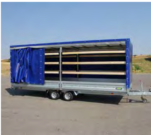
Planenaufbau mit Schiebeplane in blau RAL 5002
