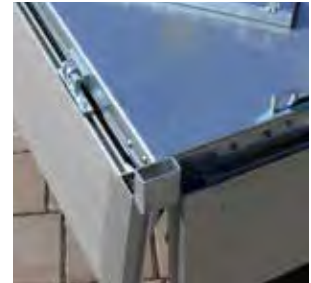
Alu-Bordwände vierseitig abklapp- und abnehmbar
