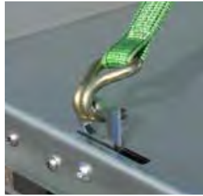
6 - 8 versenkte Zurringe mit je 600 kg
