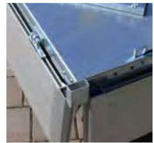
Alu-Bordwände vierseitig abklapp- und abnehmbar
