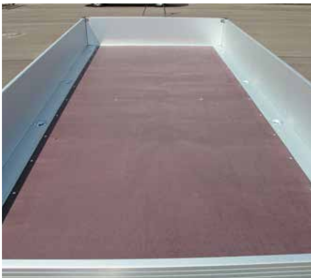
Ladefläche: Siebdruckplatte (18 mm)
