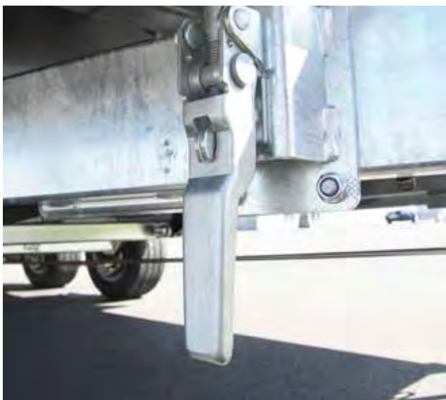
Sicherungsverschluss der Abkippfunktion
