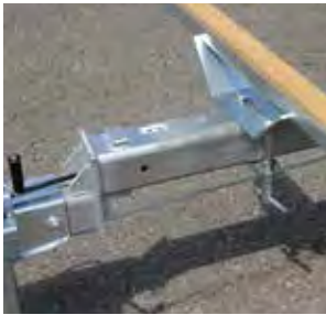
Rohrzugdeichsel werkzeuglos ausziehbar
