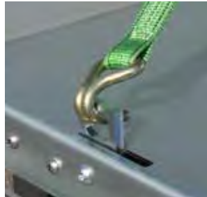
6 versenkte Zurringe mit je 600 kg
