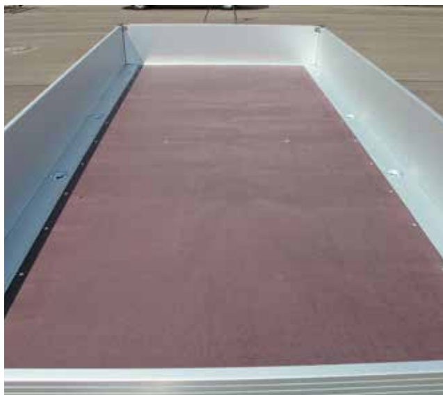
Ladefläche: durchgehende Siebdruckplatte (18 mm) bis 4.260 x 2.040 mm
