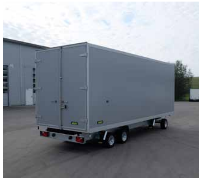
Sonderbau: Drehschemelanhänger Tridem mit Kofferaufbau für den witterungsgeschützten Transport
