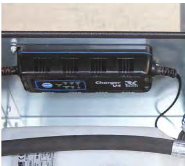
Hochfrequenzladegerät mit Erhaltungsladefunktion bei Elektrohydraulik
