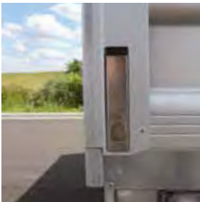
Versenkte Bordwandverschlüsse aus Edelstahl
