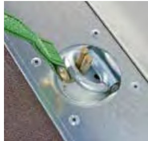
8 Zurrmulden mit je 600 kg Zugkraft Dekra zertifiziert
