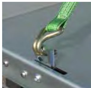
6 versenkte Zurringe mit je 600 kg
