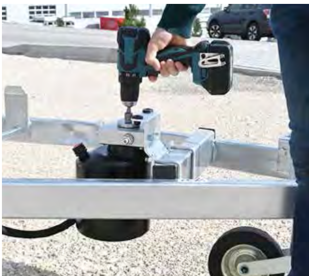
PUMPLESS - Kippen mit dem Akkuschrauber
