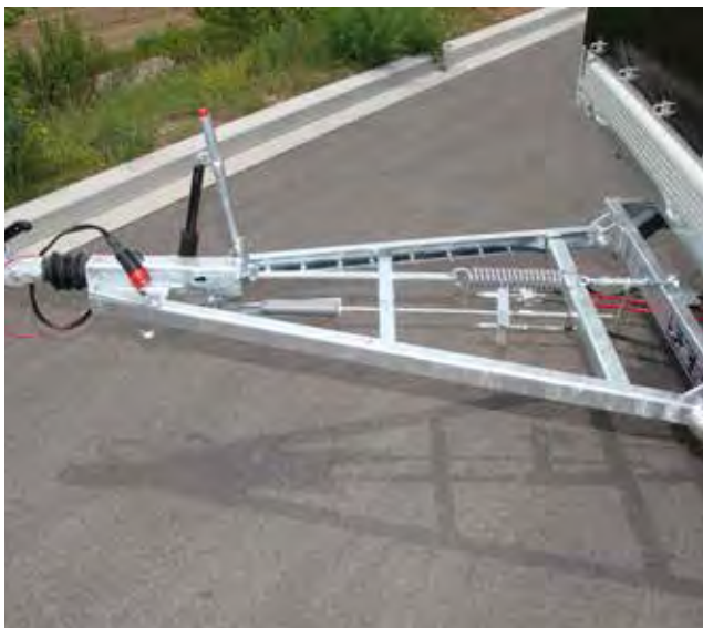
Zugdeichsel mit Drehkranz und Höhenverstellung
