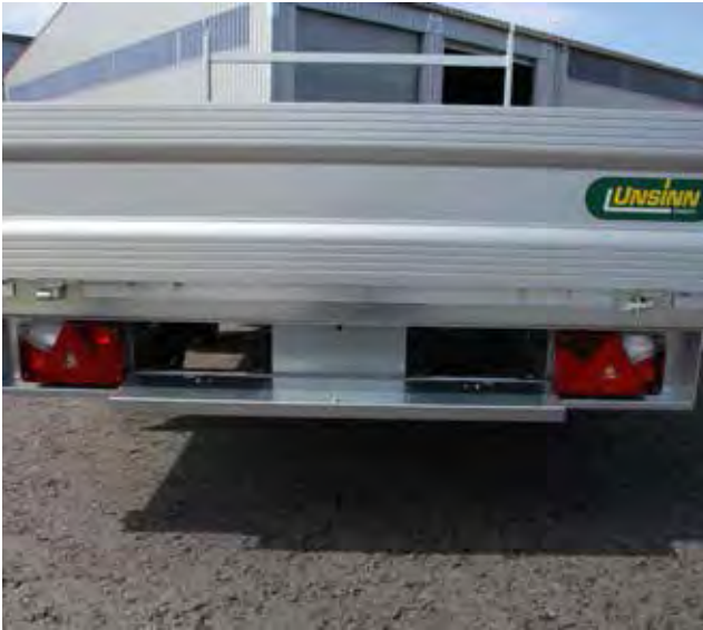
Integrierter Schacht für Auffahrschienen (unter der Ladefläche)
