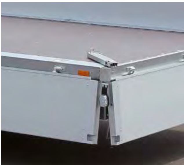
Gesteckte und abnehmbare Stahl-Eckrungen
