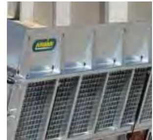
Durchgehende Stahl- gitterauffahrklappe
