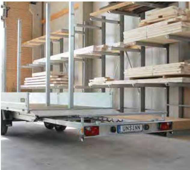
Heckleuchenträger bis 2000 mm ausziehbar
