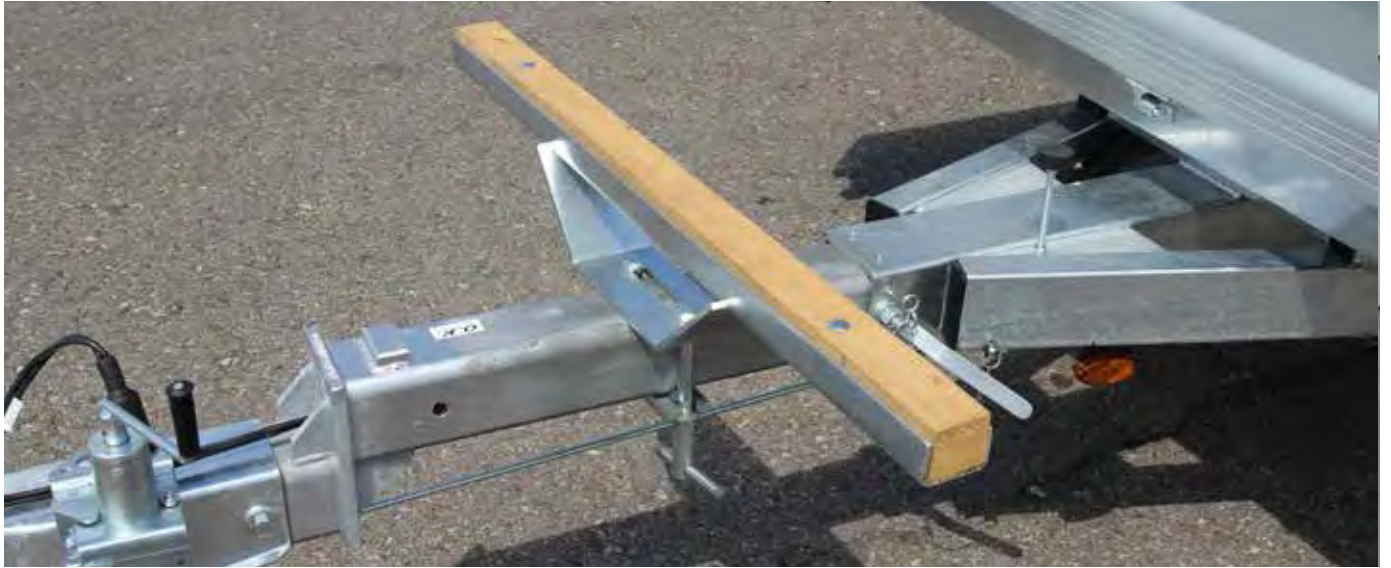
Zugdeichsel ohne Werkzeug ausziehbar mit Auflagebock
