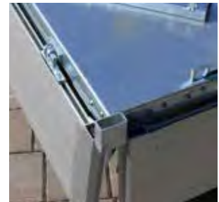
Alu-Bordwände vierseitig abklapp- und abnehmbar
