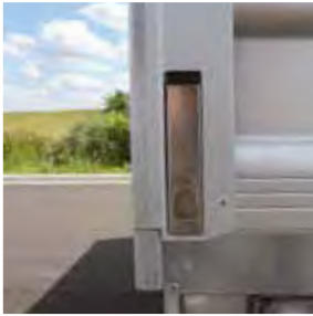
Versenkte Bordwandverschlüsse aus Edelstahl
