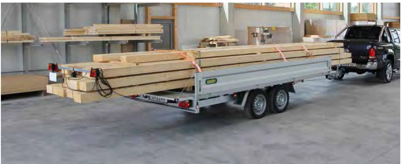
Zusätzlicher, mobiler Leuchenträger für mehr Sicherheit
