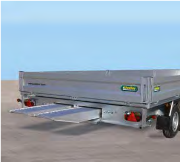
Halterung für Auffahrschienen unter der Ladefläche
