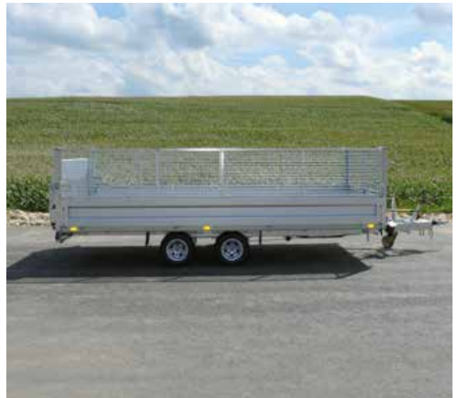
Gitteraufsatz für Schnitt- und Häckselgut
