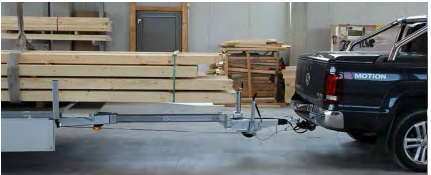
Maximale Zugdeichsellänge von 3100 mm im Standard
