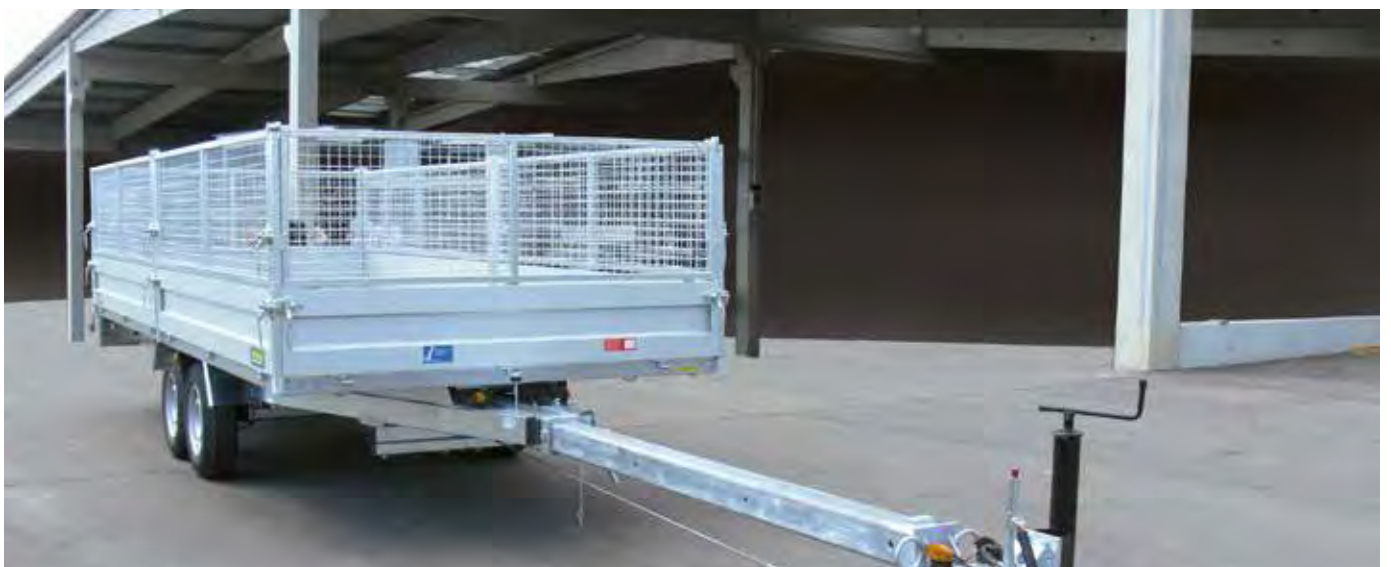
Welldrahtgitteraufsatz und Zugdeichsel in Sonderlänge
