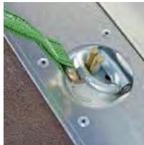
6 - 8 Zurrmulden versenkt im Bodenrahmenprofil Dekra zertifiziert
