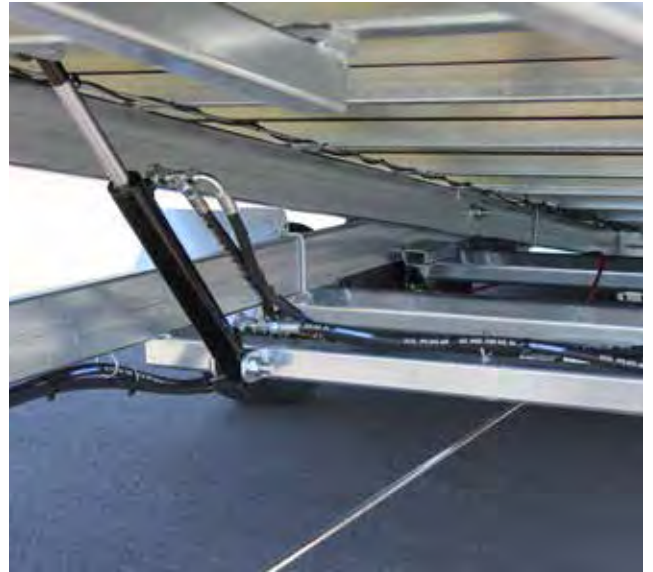
Doppelte Hydraulik für sicheren Ladevorgang
