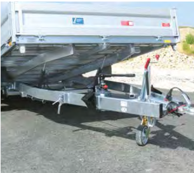
Verschweißter und feuerverzinkter Stahlrahmen
