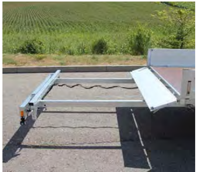
Heckleuchenträger bis 200 kg belastbar
