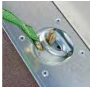
8 Zurrmulden mit je 600 kg Zugkraft Dekra zertifiziert
