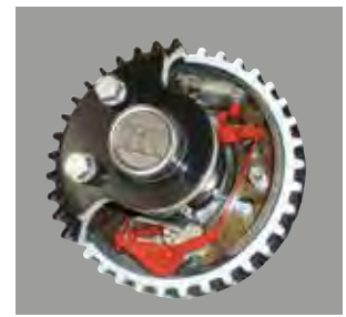
Selbstnachstellende Bremse Premium Triple A
