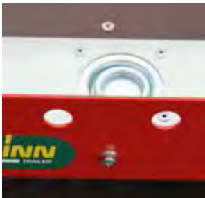
Seitenschürze mit Möglichkeit zur Ladungssicherung
